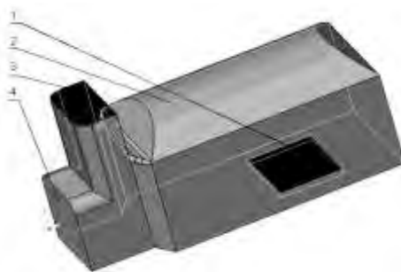
Рис. 13. Расчетная модель и граничные условия: 1 – стенка с подводом теплоты; 2 – стенка; 3 – свободный выход; 4 – вход/выход с температурой 20 °С
