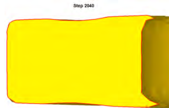
Рис.5 Сечение кольца после раскатки
