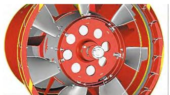
Рис. 2. Элементы сборочной модели изделия. Видны стандартные крепежные элементы и представление элементов проточной части (лопаток) в виде отдельных деталей
