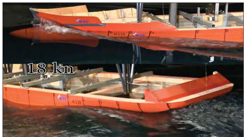
Рис. 8. Волнообразование при расчетной скорости во время модельных испытаний
