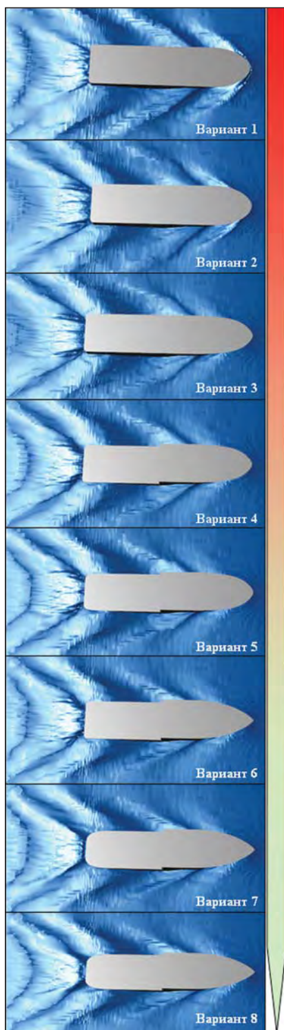
Рис. 2. Волнообразование исследованных вариантов при проектной скорости
