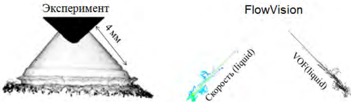
Рис. 10 - Визуализации струй, полученные в эксперименте [6] и при моделировании в FlowVision
