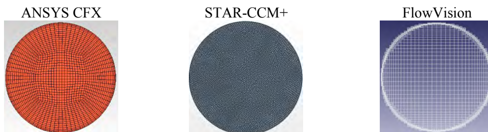
Рис. 2 – Фрагменты расчётных сеток
