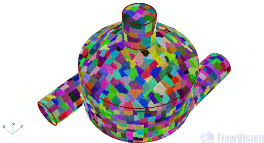
Рис. 3 - Структурирование расчетной сетки по гиперячейкам
