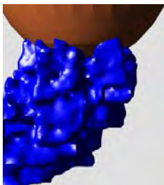
Рис.2. Поверхность струи объединяет ячейки, в которых половина объема занята водой. Слив из ВСУ на скорости 38 км/ч. Вид сбоку
