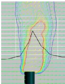
Рис. 1. Восходящий поток от очага пожара в системе координат, связанной с вертолетом, движущимся прямолинейно и равномерно.
