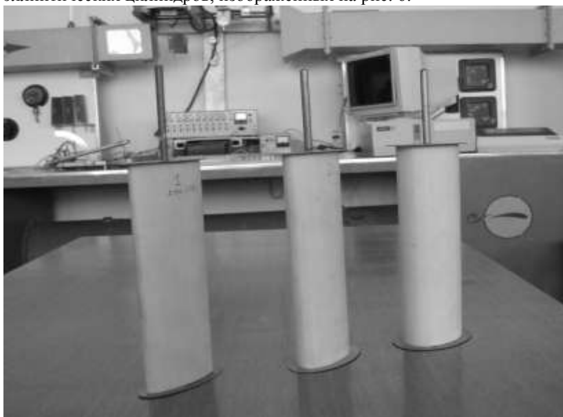
Рис.6. Модели эллиптических цилиндров Размеры цилиндров таковы:
