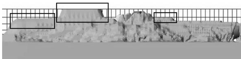
Рис. 8. Вытягивание свободной поверхности при динамической адаптации
