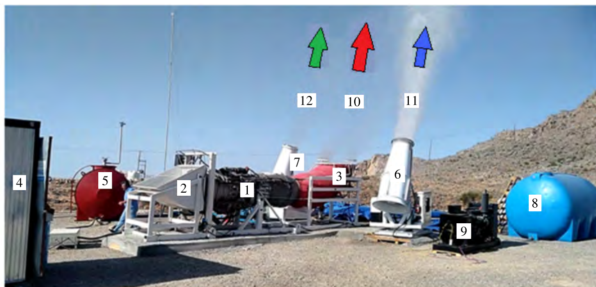
Рис. 1. Экспериментальная установка и оборудование для создания искусственных облаков: 1 – турбо-реактивный двигатель Д-30, 2 – устройство забора воздуха в двигатель, 3 – отвод струи, 4 – пусковой двигатель и система управления, 5 – топливный бак, 6 – пушка для создания аэрозоля Ю-60, 7 – пушка для создания аэрозоля WP-60, 8 – резервуар с водой для растворения гигроскопических веществ, 9 – дизель-генератор 3х380 50 кВт, питающий Ю-60, 10 – высокотемпературная струя выхлопа реактивного двигателя, 11 – поток аэрозоля из пушки Ю-60, 12 – поток аэрозоля из пушки WP-60 [Abshaev et al., 2023]
