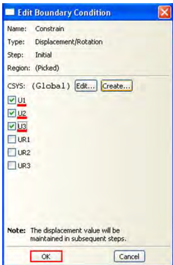
Рисунок. 6.85 - Изменение граничного условия Constrain
