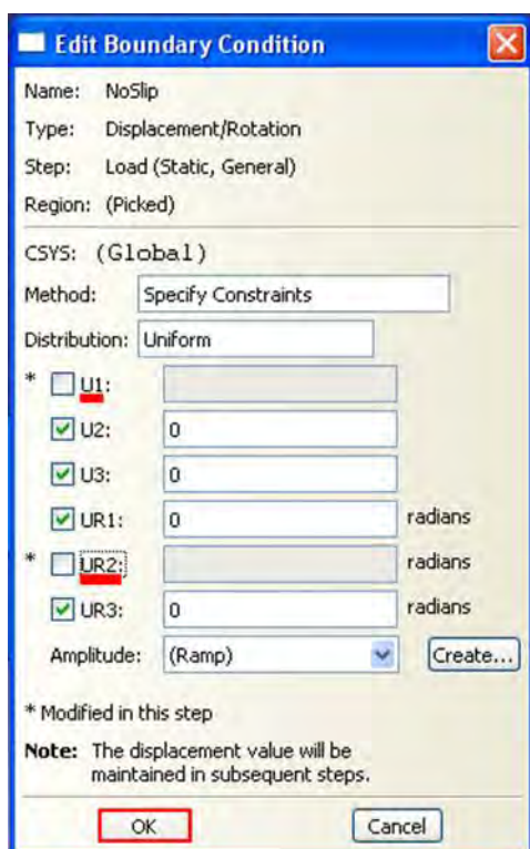
Рисунок. 6.84 – Изменение граничного условия NoSlip
