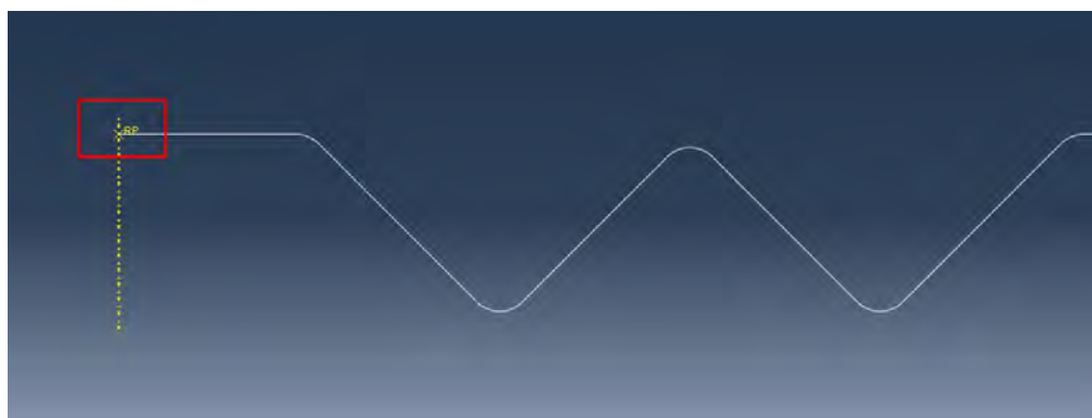
Рисунок 14.8 – Расположение Reference Point
