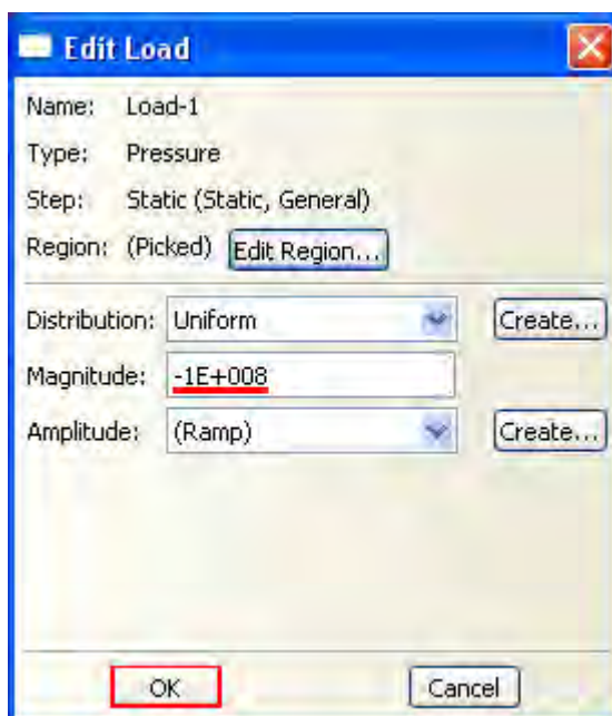
Рисунок 9.21 – Задание значения давления нагружения
