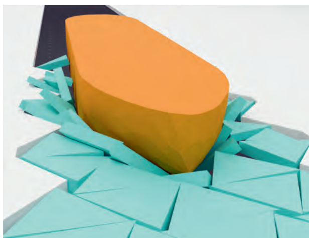
Рис. 7. Результат моделирования 6 с расчета столкновений массива льдин с корпусом судна в канале
